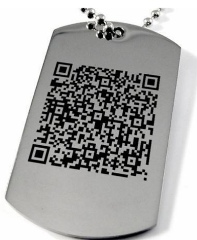
Рис. 2. Лазерная маркировка QR-кода на жетоне.
