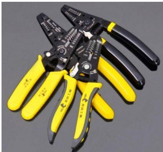
Рис. 9. Стрипперы для удаления изоляции.
