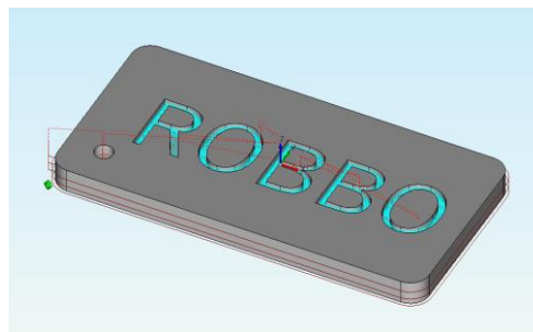
Рис. 2. Траектория движения фрезы.
