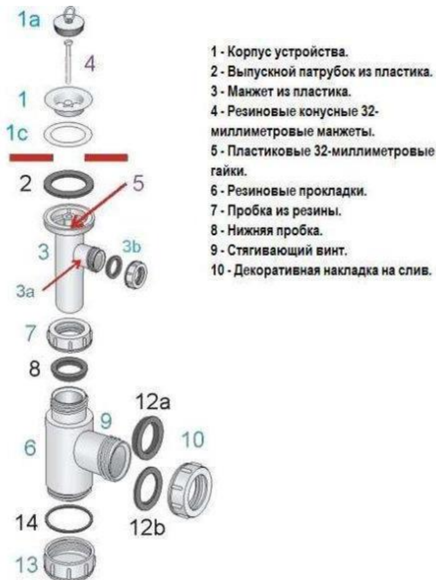
Рис. 4. Последовательность действий при сборке сифона для раковины.
